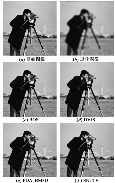
图1 各种方法在均匀模糊、 \text{BSNR}=40\text{dB} 的Cameraman 图像上的实验结果
